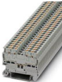
Blocs de jonction simple, Mode de raccordement: Raccordement Push-in, section :0,14 mm<sup>2</sup> - 2,5 mm<sup>2</sup>, AWG: 26 - 12, Largeur: 5,2 mm, Hauteur: 35,3 mm, Coloris: gris, Type de montage: NS 35/7,5, NS 35/15
