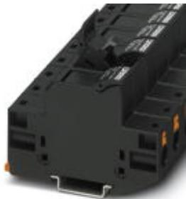
Bloc de jonction-fusibles, Type de raccordement: Raccordement Push-in, section :1,5 mm<sup>2</sup>- 10 mm<sup>2</sup>, AWG: 16 - 6, Intensité nominale: 20 A, Tension nominale: 1000 V, Largeur: 17,6 mm, Type de fusible: Midget / 10,3 x 38, Type de montage: NS 35/7,5, NS 35/15, Coloris: noir
