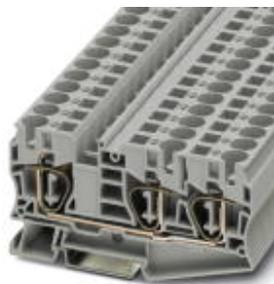
Blocs de jonction simple, Mode de raccordement: Raccordement à ressort, section :0,2 mm<sup>2</sup> - 16 mm<sup>2</sup>, AWG: 24 - 6, Largeur: 10,2 mm, Coloris: gris, Type de montage: NS 35/7,5, NS 35/15
