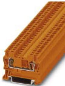
Blocs de jonction simple, Mode de raccordement: Raccordement à ressort, section :0,08 mm<sup>2</sup> - 4 mm<sup>2</sup>, AWG: 28 - 12, Largeur: 5,2 mm, Coloris: orange, Type de montage: NS 35/7,5, NS 35/15
