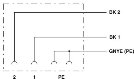
Disposition des contacts du connecteur pour électrovannes
