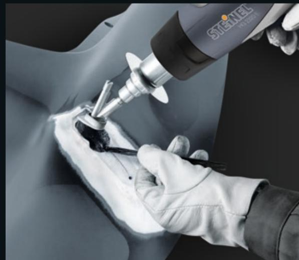
Réparer des fissures dans les pare-chocs.
