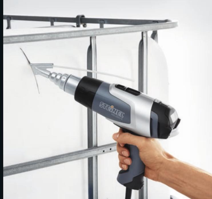
▲ Soudage d'un réservoir d'eau
