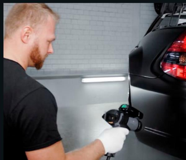
Air chaud et prise de la température d'une seule main lors des travaux de pelliculage des véhicules.
