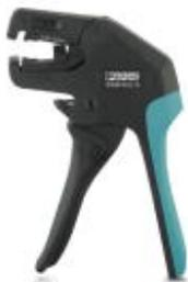
Outil à dénuder, pour câbles et conducteurs de 0,02 - 10 mm<sup>2</sup>, réglage automatique, longueur à dénuder jusqu'à 18 mm, capacité de sectionnement jusqu'à 10 mm<sup>2</sup> flexible/ 1,5 mm<sup>2</sup> rigide, couteau de dénudage remplaçable
