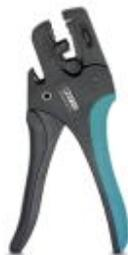
Outil à dénuder, pour câbles et conducteurs de 0,02 - 10 mm<sup>2</sup>, réglage automatique, longueur à dénuder jusqu'à 18 mm, capacité de sectionnement jusqu'à 10 mm<sup>2</sup> flexible/ 1,5 mm<sup>2</sup> rigide, couteau de dénudage remplaçable
