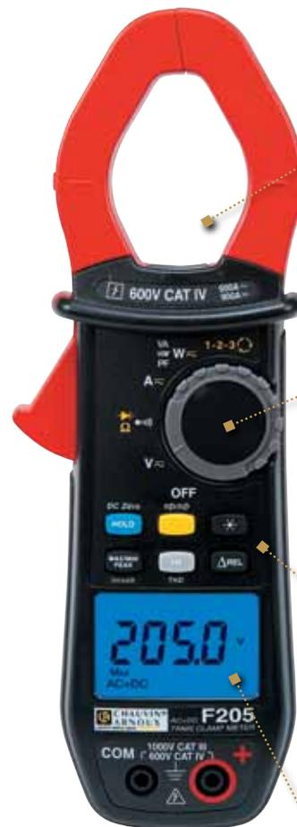
Différents diamètres d'enserrage, jusqu'à 60 mm, sont disponibles afin de réaliser aisément les mesures.
