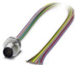
Connecteur mâle encastrable pour capteurs/actionneurs, 12 pôles, SPEEDCONNEC M12, montage vissé/sur face avant, filetage M16, avec cordon PVC de 0,5 m, 12 x 0,14 mm<sup>2</sup>
