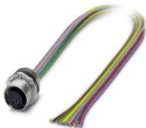
Connecteur femelle encastrable pour capteurs/actionneurs, 12 pôles, SPEEDCONN M12, montage vissé/ sur face avant, filetage M16, avec cordon PVC de 0,5 m, 12 x 0,14 mm<sup>2</sup>
