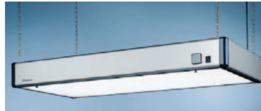
Plafonnier lumière du jour Waldmann ALE 458 pour un niveau d'éclairage élevé. Les tubes devant être remplacés après 2000 heures de service en raison de la modification du spectre lumineux dans le temps et du rendu des couleurs, un compteur d'heures est intégré dans le cadre en tôle d'acier laqué.
