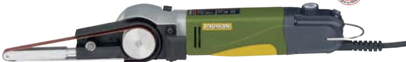
**Pour le ponçage de petites ouvertures, le finissage de formes et de surfaces, le polissage de rainures, le limage d'ébarbures et l'aplatissage de petites surfaces.** Tête de transmission en fonte d'aluminium pour une grande stabilité et un ajustement précis grâce aux roulements à billes. Boîtier central en POLYAMIDE renforcé de fibre de verre. Moteur spécial DC équilibré, puissant, silencieux et durable.
