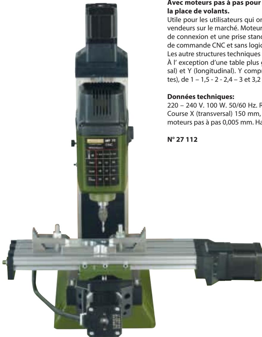
**Avec moteurs pas à pas pour l'axe X (transversale), Y (longitudinale) et Z (hauteur) à la place de volants.**
