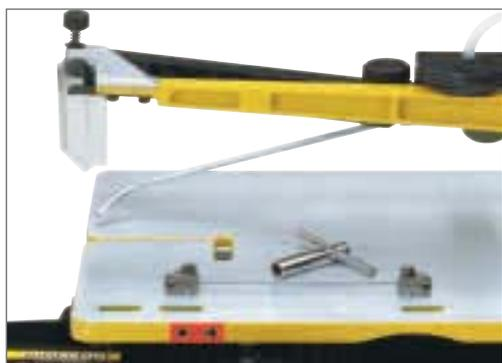
**Les pierres de coulisse (breveté) permettent avec un effort élevé,** d'assurer un alignement précis des lames. Les cavités dans la surface de la table servent de ligne de guide pour définir la position et l'assemblage de la lame de scie.
