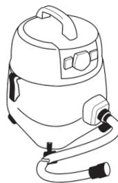
Les deux appareils sont équipés d'un raccord d'aspiration et adaptateur pour un ponçage propre, sans poussières. Nous recommandons l'utilisation de notre aspirateur d'atelier CW-matic (page 48) avec commande de commutation intégré : L'aspirateur marche pendant le ponçage et continu à aspirer pendant 5.sec dès l'arrêt de la machine.
