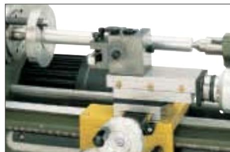
**Dispositif de tournage entre-pointes pour PD 400**
