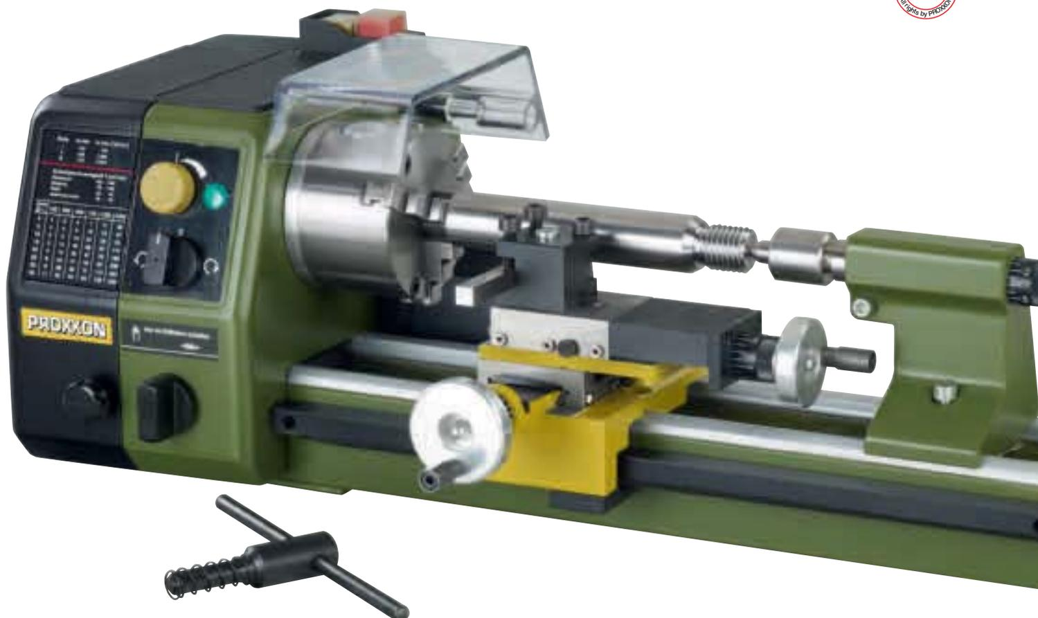
**Entre-pointes 250 mm. Hauteur des pointes 70 mm. Hauteur au dessus du support 46 mm.**
