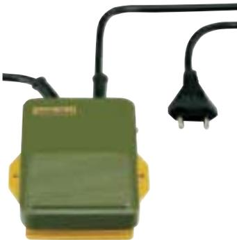
Pour tous les appareils à fiche européenne (classe 2) et d'une puissance jusqu'à 500 W max. Convient aussi aux appareils d'établi. Boîtier en NYLON renforcé de fibre de verre. Cordon 250 cm pour secteur 230 V. 50 cm de câble en sortie. Pour les appareils 12 V, l'interrupteur peut être branché au transfo. N° 28 700
