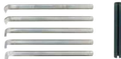
Pour filetages métriques 60° et Whitworth 55°. 1 pièce de 1,3 – 2,65 et 4 mm. Axe Ø 6 mm. Longueur totale 95 mm. Les burins sont à placer dans le porte-outil fourni (8 x 8 mm) et à serrer dans le porte-outil du PD 230/E, PD 250/E ou PD 400. Dans une boîte en bois avec couvercle coulissant.
