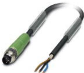
Câbles pour capteurs/actionneurs, 3-pôles, Type de câble variable, blindé, Connecteur droite M8, sur extrémité libre, Longueur du câble: Longueur au choix (0,2... 40,0 m)
