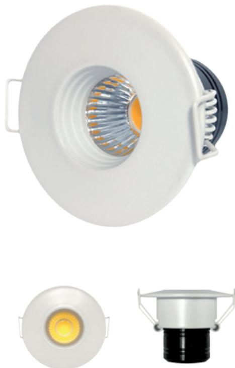
Spot d'intérieur encastrable à LED 3W à encombrement réduit (seulement 35mm de hauteur pour 50mm de diamètre). Technologie Chip-on-board pour un maximum de luminosité. Angle de 60°. Corps en aluminium blanc. Fixation facile par languettes de maintien montées sur ressorts. Livré avec un contrôleur d'alimentation.
