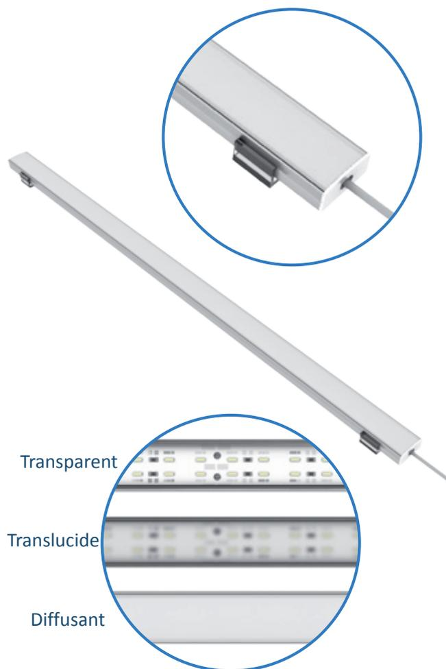
Luminaires basse tension à LED ultra-plats et à haute efficacité (100 lm/W). Longueurs de 25 cm à 2 m et puissances de 6 à 48 W. Corps en profilé aluminium satiné ultra-fin. Fixation facile par clips transparents à visser. Existe en version 24DC (alimentable sur secteur via contrôleur dédié) et 12DC pour alimentation sur batteries. Raccordement sur câble.
