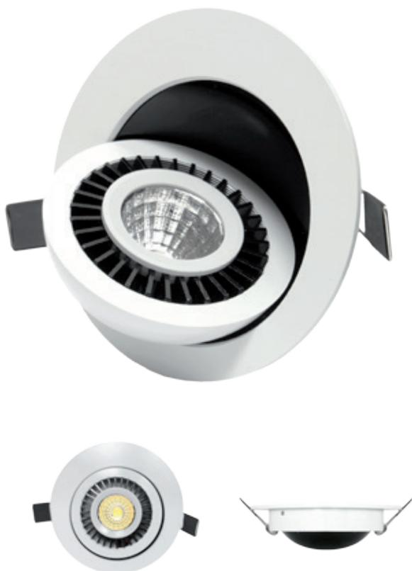
Spot d'intérieur encastrable à LED 7W orientable sur deux axes et pouvant pivoter jusqu'à 90°. Idéal pour l'éclairage de produits / tableaux. Technologie Chip-on-board pour un maximum de luminosité. Angle de 85°. Corps en aluminium blanc. Fixation facile par languettes de maintien montées sur ressorts. Livré avec un contrôleur d'alimentation.
