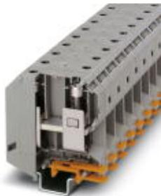
BJ pour courant, Mode de raccordement: Raccordement vissé, section :25 mm<sup>2</sup> - 95 mm<sup>2</sup>, AWG: 4 - 3/0, Largeur: 25 mm, Hauteur: 90 mm, Coloris: gris, Type de montage: NS 35/15, NS 32
