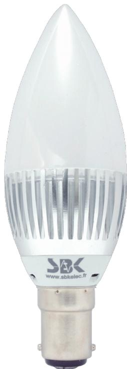
Ampoule 3W à technologie LED, forme «flamme» (format B) avec culot B15. Haute efficacité (90 lm / W). Enveloppe en polycarbonate diffusant. Angle de 165°. Disponible en trois nuances de blanc.
