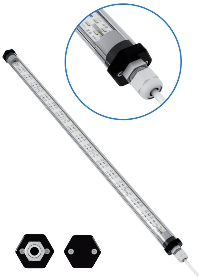
Luminaires basse-tension à LED ultra-résistants et ultra-efficace (100 lm/W). Très haute luminosité pour un faible encombrement (seulement 25mm de diamètre) Structure tubulaire en polycarbonate étanche IP65 résistante aux chocs. Disponibles en longueur de 25 cm à 2 m et puissances de 6 à 48 W.
