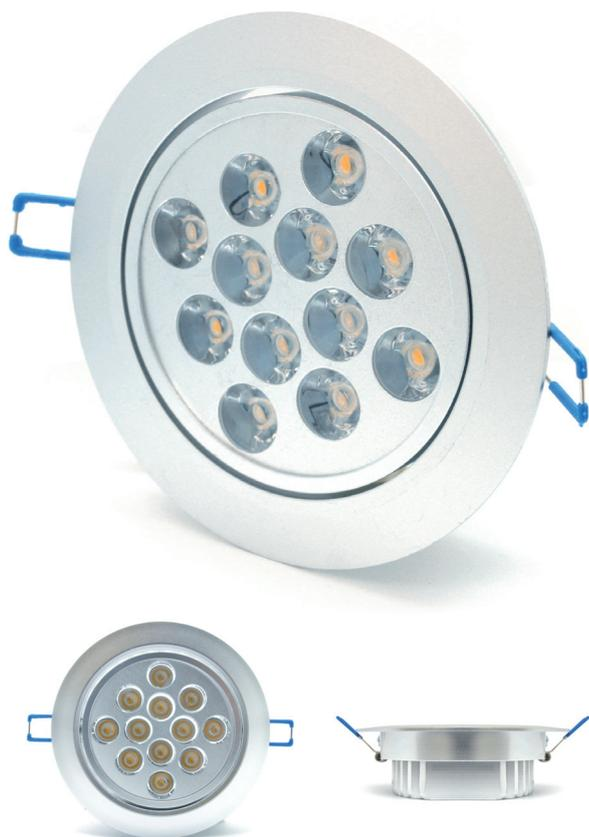
Spot d'intérieur encastrable à LED 12 W. Corps en aluminium aspect satiné. Fixation facile par languettes de maintien montées sur ressorts. Orientable sur un axe. Disponible en angle de 45° et 60° et trois nuances de blanc. Livré avec contrôleur d'alimentation secteur.
