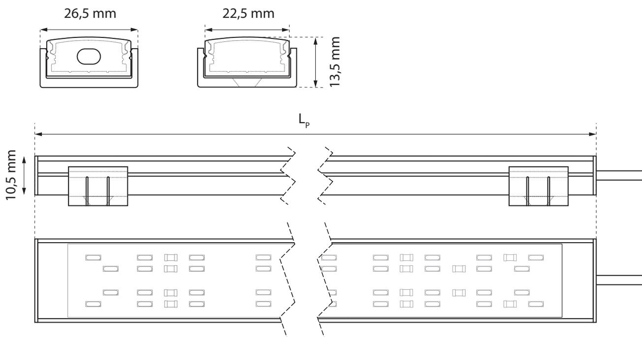
Les modèles Profyslim 24DC sont proposés en longueurs de 50 cm, 100 cm, 150 et 200 cm (puissances respectives de 12 / 24 / 36 et 48 W). Ils s'alimentent sur secteur via leur contrôleur d'alimentation CAL24 dédié (voir page 14) ou sur une source 24 V<sub>DC</sub> de puissance appropriée.
