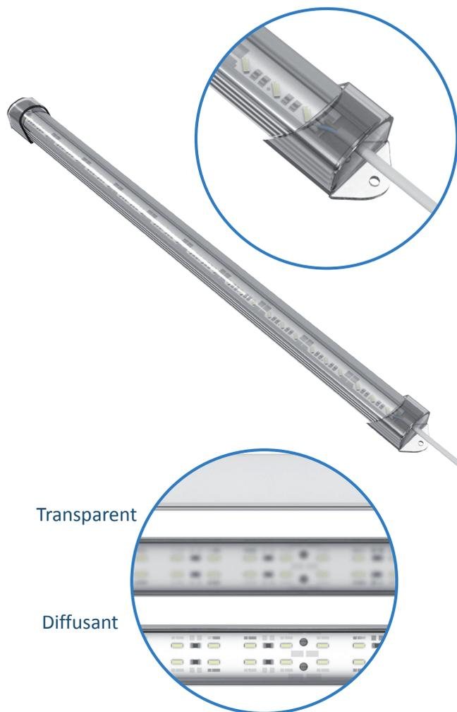
Luminaire 12 V économique de faible encombrement. Corps en profilé aluminium, trois longueurs disponibles: 32 / 64 et 96 cm pour une puissance respective de 5, 10 et 15 W. Fixation par vis et raccordement sur câble.
