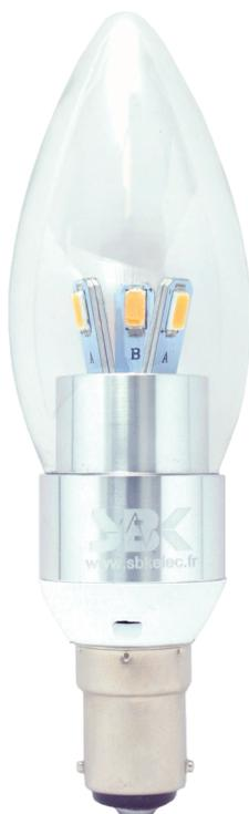
Ampoule 3W à technologie LED, forme «flamme» (format B) avec culot B15. Enveloppe transparente en verre. Angle de 360° pour un éclairage omnidirectionnel. Disponible en trois nuances de blanc.
