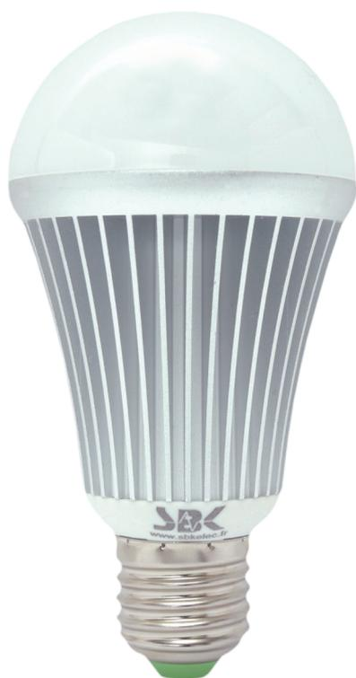
Ampoule 10W à technologie LED au format standard A avec culot E27. Très haute luminosité et haute efficacité (94 lm / W). Angle de 130°. Disponible en trois nuances de blanc.
