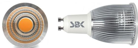
Ampoule 7W à technologie LED au format PAR20 avec culot GU10. Technologie Chip-On-Board pour un maximum de luminosité dans un encombrement réduit. Angle de 85°. Disponible en trois nuances de blanc et en version dimmable ou non dimmable.
