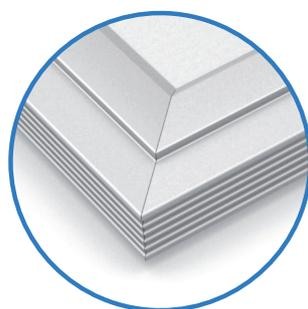
Dalle de plafond 42 W ultra-plate à LED conçue pour s'intégrer dans les faux plafonds. Très haute luminosité et haute efficacité ( 4000 lm et 95 lm / W). Angle de 90°. Cadre en aluminium aspect satiné de 12 mm d'épaisseur avec bords ultra-fin et surface lumineuse en PMMA diffusant. Attaches de fixation sur face arrière. Livrée avec contrôleur d'alimentation secteur.
