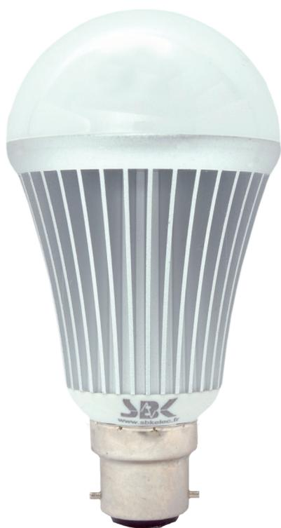
Ampoule 10W à technologie LED au format standard A avec culot B22. Très haute luminosité et haute efficacité (94 lm / W). Angle de 130°. Disponible en trois nuances de blanc.
