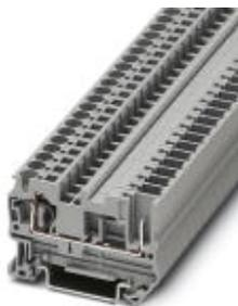
BJ simple, Mode de raccordement: Raccord par tension à ressort/enfichable, section :0,08 mm<sup>2</sup> - 6 mm<sup>2</sup>, AWG: 28 - 10, Largeur: 6,2 mm, Coloris: gris, Type de montage: NS 35/7,5, NS 35/15
