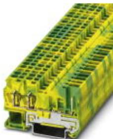
BJ à ressort pour conducteur de protection, Mode de raccordement: Raccord par tension à ressort/enfichable, section :0,08 mm<sup>2</sup> - 4 mm<sup>2</sup>, AWG: 28 - 12, Largeur: 5,2 mm, Coloris: vert/jaune, Type de montage: NS 35/7,5, NS 35/15
