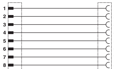
Disposition des contacts des connecteurs M12 mâles et femelles
