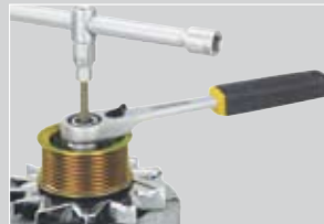
Pour le montage/ démontage de courroies crantées sur des alternateurs (24 mm).
