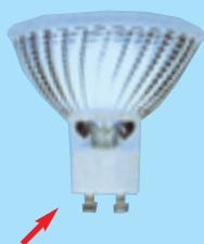
Bon à savoir : un culot GZ10 a des bords à angle droit (voir flèche rouge sur photo). Ce type de culot est uniquement monté sur les lampes munies d'un réflecteur dichroïque. Elles peuvent être placées sur des spots conçus et homologués pour supporter les fortes températures résultant du dégagement de 70 % de la chaleur par l'arrière de la lampe, (effet dichroïque).
