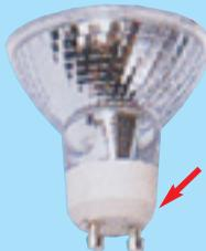
Bon à savoir : un culot GU10 a des bords biseautés à 45° (voir flèche rouge sur photo). Ce type de culot est uniquement monté sur les lampes munies d'un réflecteur aluminium. Elles doivent être placées sur des spots conçus et homologués seulement pour permettre un dégagement de la chaleur par l'avant (pas d'effet dichroïque).
