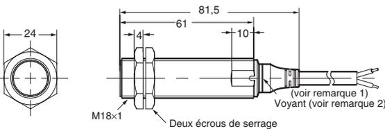
**Remarque 1.** Câble rond vinyle isolé dia. 4 avec 3 conducteurs (section des conducteurs : 0,3 mm<sup>2</sup> ; diamètre de l'isolant : 1,3 mm) ; longueur standard : 2 m
