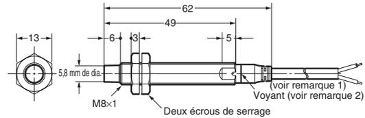
**Remarque 1.** Câble rond vinyle isolé dia. 4 avec 3 conducteurs (section des conducteurs : 0,3 mm<sup>2</sup> ; diamètre de l'isolant : 1,3 mm) ; longueur standard : 2 m
