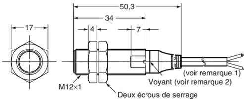
Remarque 1. Câble rond vinyle isolé dia. 4 avec 3 conducteurs (section des conducteurs : 0,3 mm<sup>2</sup> ; diamètre de l'isolant : 1,3 mm) ; longueur standard : 2 m
