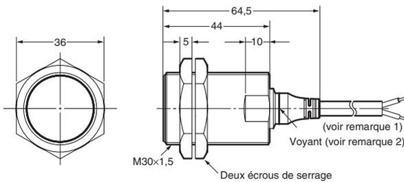
Remarque 1. Câble rond vinyle isolé dia. 4 avec 3 conducteurs (section des conducteurs : 0,3 mm<sup>2</sup> ; diamètre de l'isolant : 1,3 mm) ; longueur standard : 2 m
