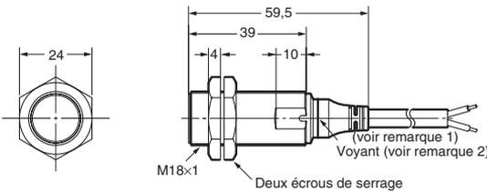
Remarque 1. Câble rond vinyle isolé dia. 4 avec 3 conducteurs (section des conducteurs : 0,3 mm<sup>2</sup> ; diamètre de l'isolant : 1,3 mm) ; longueur standard : 2 m
