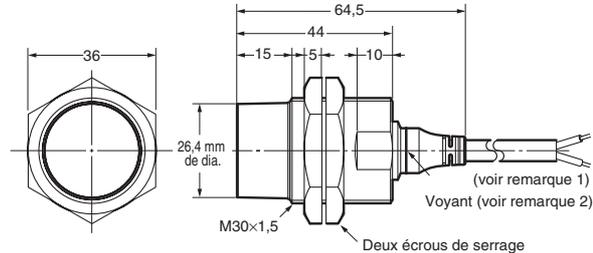
Remarque 1. Câble rond vinyle isolé dia. 4 avec 3 conducteurs (section des conducteurs : 0,3 mm<sup>2</sup> ; diamètre de l'isolant : 1,3 mm) ; longueur standard : 2 m
