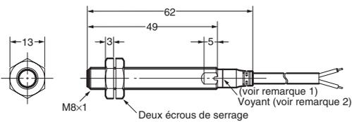
**Remarque 1.** Câble rond vinyle isolé dia. 4 avec 3 conducteurs (section des conducteurs : 0,3 mm<sup>2</sup> ; diamètre de l'isolant : 1,3 mm) ; longueur standard : 2 m
