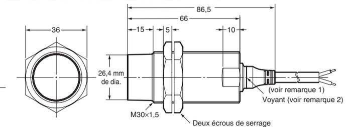
**Remarque 1.** Câble rond vinyle isolé dia. 4 avec 3 conducteurs (section des conducteurs : 0,3 mm<sup>2</sup> ; diamètre de l'isolant : 1,3 mm) ; longueur standard : 2 m
