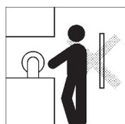
Un travailleur se trouve entre la zone de détection du capteur et la partie dangereuse de la machine.
