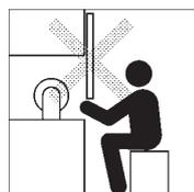
Il est possible d'atteindre une partie dangereuse d'une machine sans passer dans la zone détectée par le capteur.
