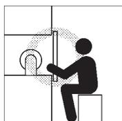
Il est possible d'atteindre une partie dangereuse d'une machine uniquement en passant dans la zone de détection du capteur.
