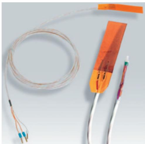
Sonde : Pt 100 CEI 60751 classe A, simple enroulement, élément de mesure couche mince sous rétractable PFA (Température d'utilisation : -50 à +250 °C), sous film polyester (Température d'utilisation : -80+160 °C)
