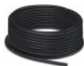
Câble principal pour répartiteurs pour capteurs/actionneurs, avec conducteur PE, non blindé, matériel PUR/PVC, 11 pôles, 8 x 0,34 mm<sup>2</sup> et 3 x 0,75 mm<sup>2</sup>
