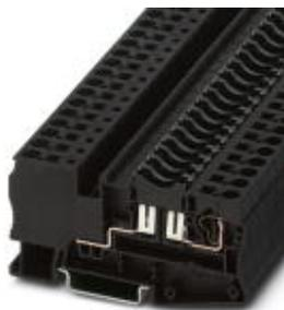
BJ-fusibles, Type de raccordement: Raccordement à ressort, section :0,08 mm<sup>2</sup>- 6 mm<sup>2</sup>, AWG: 28 - 10, Intensité nominale: 30 A, Tension nominale: 400 V, Largeur: 8,2 mm, Type de fusible: C, Type de fusible: Plat, Type de montage: NS 35/7,5, NS 35/15, Coloris: noir
