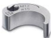
Pièce enfichable pour le montage des câbles pour capteurs/actionneurs à connecteur mâle M12 et pour connecteur mâle M12 à technique de raccordement rapide QUICKON, pour entraînement hexagonal de 4mm
