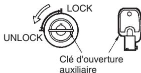
La clé d'ouverture auxiliaire installée sur la porte d'une salle de machines assure la sécurité des personnes qui utilisent l'équipement dans la salle. Lorsqu'elle est réglée sur UNLOCK, la porte n'est pas verrouillée lorsqu'elle est fermée et les machines ne sont pas alimentées.
