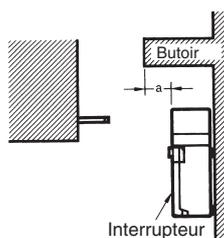
N'utilisez pas l'interrupteur en tant que butoir. Lors de la fixation de l'interrupteur, placez un butoir comme sur l'illustration suivante pour empêcher le haut de la clé de frapper la tête de l'interrupteur.
