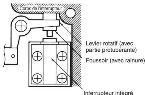
Prenez soin de contrôler les fonctions de verrouillage mécanique et de déverrouillage de l'électro-aimant lors du montage du D4BL.
