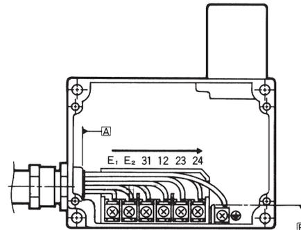
Serrez chaque borne câblée dans le sens des aiguilles d'une montre à un couple de serrage de 0,59 à 0,78 N·m.
