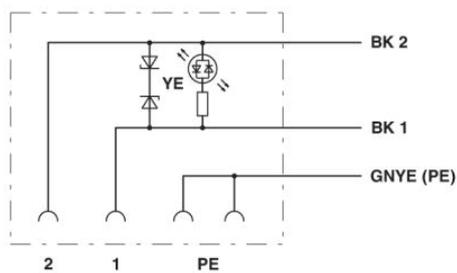
Disposition des contacts du connecteur pour électrovannes
