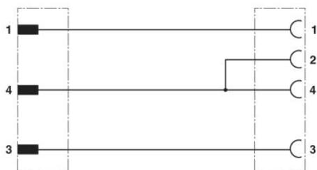
Disposition des contacts des connecteurs mâles/femelles M12, pontés
