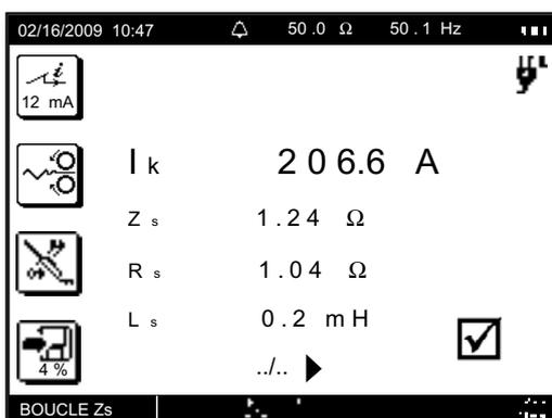
La mesure Zs représente l'impédance de la boucle Phase-Terre (L-PE). Cette mesure permet de :
