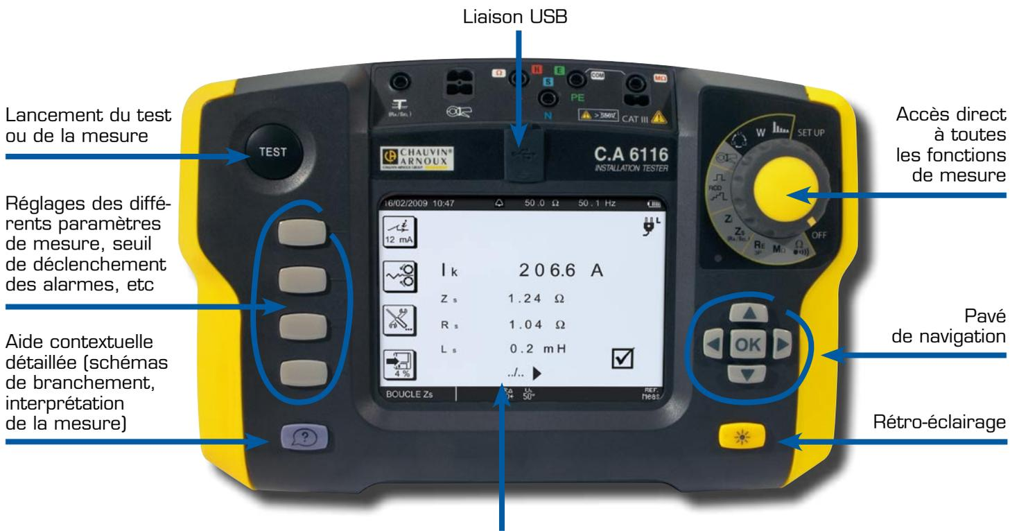
Large écran graphique permettant un grand confort de lecture et une navigation aisée dans l'appareil
