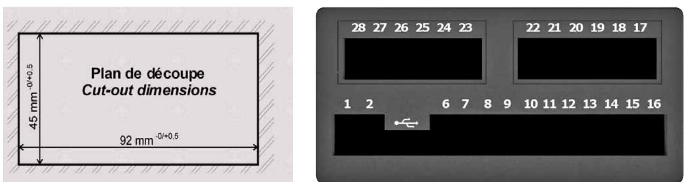
Profondeur maximale avec connecteurs : 95mm
