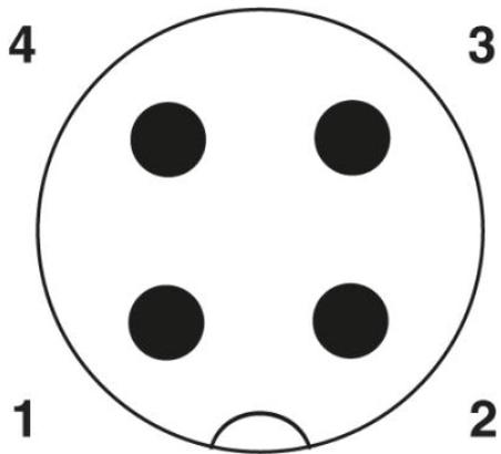
Schéma des pôles connecteur mâle M12,
