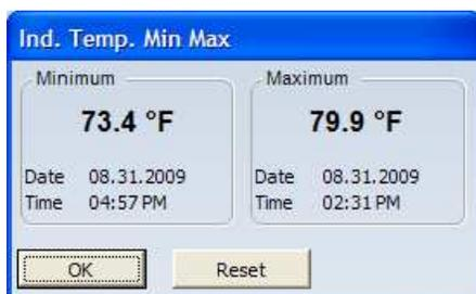
Ci-contre un exemple de consultation des détails des Mini et Maxi. Une ré-initialisation des Mini et Maxi est également possible à partir de
