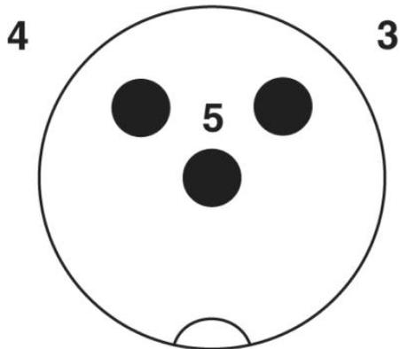
Schéma des pôles connecteur mâle M12,
