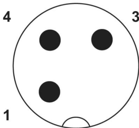
Schéma des pôles connecteur mâle M12,
