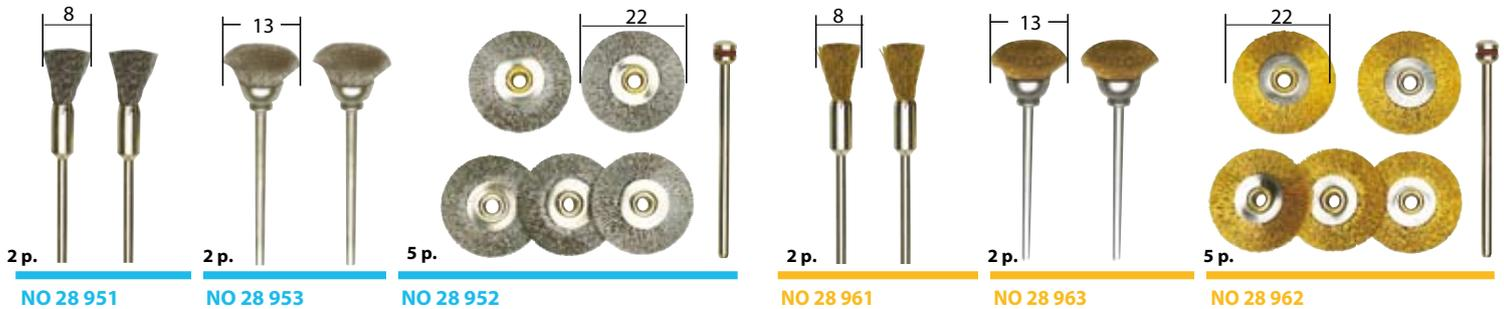
**Brosses en acier de forme pinceau fin, ronde et disque.** Qualité supérieure pour un rendement optimal. Pour le nettoyage, dérouillage, ébarbage, dépolissage, rabotage, arrondissement, etc. de métal, de fonte, de plastique, de pierre et de bois. Axe  $\varnothing$  2,35.
