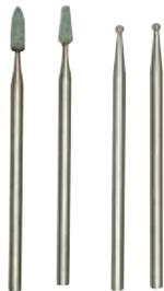
**Set de gravure sur verre, 4 pièces.** 2 meules diamantées sur tige et 2 meules sur tige en carbure de silicium. Pour gravure, taille et dépolissage du verre. Meule diamantée à tige 1 : sphère  $\varnothing$  1,0 mm, meule diamantée à tige 2: sphère  $\varnothing$  1,8 mm, cône en carbure de silicium 3/2 x 5 mm, de même que pour la forme projectile 2/2,5 x 7 mm. Chaque tige :  $\varnothing$  2,35 mm.
