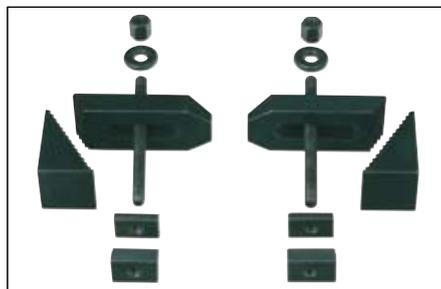
A chaque fois 2 blocs étagés, 2 pattes, 2 écrous et 2 blocs pour gorges en T (B = 7 mm, E = 12 mm, D = 4 mm, C = 7,2 mm). Pour pièces à usiner jusqu'à 35 mm env. d'épaisseur. Utilisable sur PD 230/E, PF/FF 230, PD 400, PF/FF 400, FF 500, BFB 2000, plateau de tournage 24 412 et KT 150.
