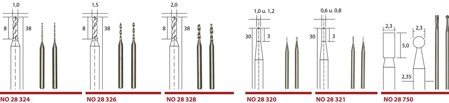
**Micro-forets en métal renforcé** En métal renforcé résistant à l'usure. Pour le travail du verre, des pierres semi-précieuses, de la porcelaine, de la céramique, du marbre et d'autres pierres dures. La dureté de pierres est catégorisée sur une échelle de 1 à 10. Jusqu'à la dureté 6, l'utilisation de métal renforcé est possible, pour une dureté supérieure à 6, les accessoires diamantés sont à utiliser. Axe  $\varnothing$  3,0 mm. Angle de coupe idéale de 6°.
