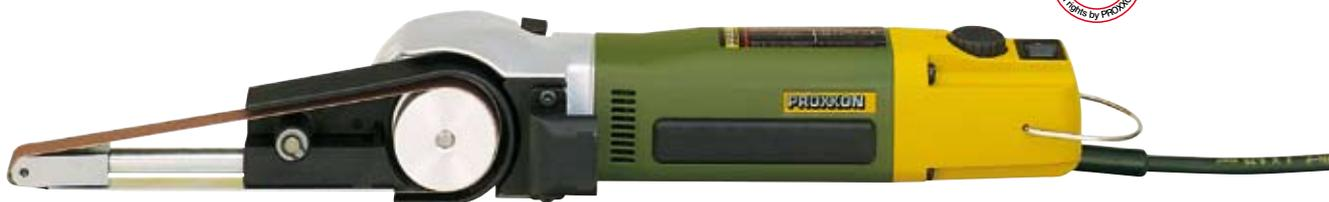
**Pour le ponçage de petites ouvertures, le finissage de formes et de surfaces, le polissage de rainures, le limage d'ébarbures et l'aplatissage de petites surfaces.** Tête de transmission en fonte d'aluminium pour une grande stabilité et un ajustement précis grâce aux roulements à billes. Boîtier central en POLYAMIDE renforcé de fibre de verre. Moteur spécial DC équilibré, puissant, silencieux et durable.
