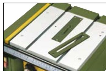
Couverture non fendue du passage de lame de scie en ABS pour des tolérances étroites entre lame de scie et table (est fendue par en dessous par la lame de scie de la FET). Pour découper des pièces de petite taille.
