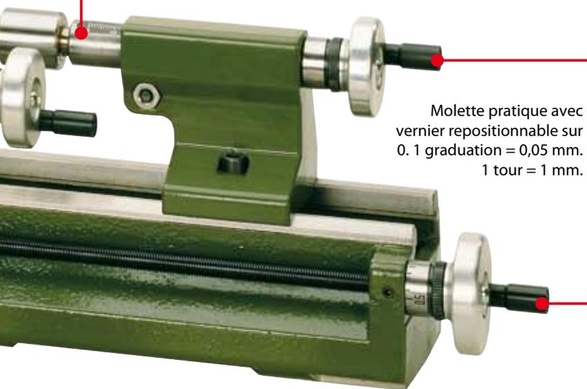
Molette pratique avec vernier repositionnable sur 0.1 graduation = 0,05 mm.
