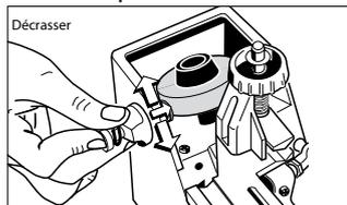
Le dispositif de décrassage intégré nettoie la meule par simple pression sur le bouton.
