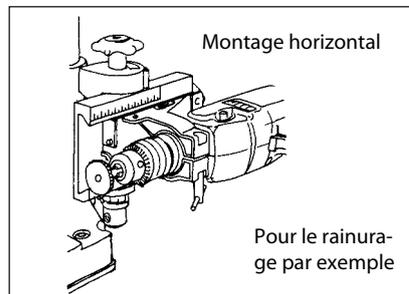
**Tête inclinable jusqu'à 90°, permettant de nombreuses possibilités d'utilisation:** perçage oblique, fraisage varié sans fraises spéciales et fraisage de trous obliques.
