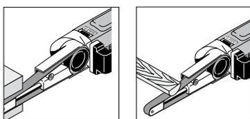
Réglage progressif du régime (électronique à onde pleine). Basculement du bras de ponçage jusqu'à 60° par simple pression sur le bouton. Les supports et l'adaptateur pour aspirateur permettent un travail propre. Livrée avec 4 bandes de ponçage (2 à G 80 et 2 à G 180). Rangement sûr dans une attrayante mallette robuste en plastique de qualité, comme décrite page 6.
