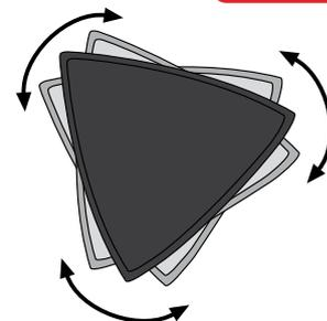
L'oscillation évite les vibrations et donc le broutage. Un autre avantage: elle s'utilise aussi avec des lames à tronçonner!
