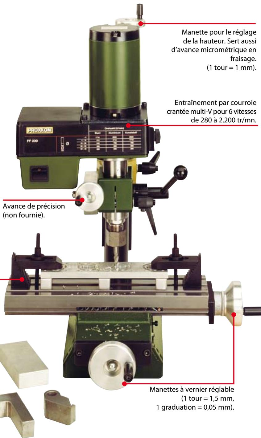
Manette pour le réglage de la hauteur. Sert aussi d'avance micrométrique en fraisage. (1 tour = 1 mm).
