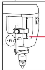
Moteur à courant continu puissant et durable. Entraînement du mandrin par poulie 3 étages présentant l'avantage d'un couple presque 6 fois supérieur dans la plage basse de régimes. Affichage pratique de la profondeur de perçage avec butée réglable. Mandrin de perçage monté sur paliers de précision. Tête de broche avec filetage 1/2" pour le mandrin à couronne dentée RÖHM correspondant (qualité industrielle). Mandrin équipé d'un logement supplémentaire pour pinces de serrage en acier NO 28 200.
