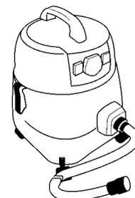
Dispositif de refroidissement pour le ponçage à l'eau (de verre, pierre, carrelages, acier).
