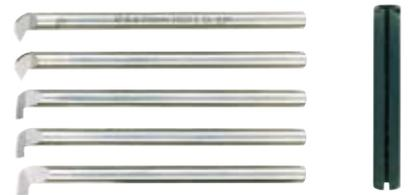
Pour filetages métriques 60° et Whitworth 55°. 1 pièce de 1,3 - 2,65 et 4 mm. Axe ø 6 mm. Longueur totale 95 mm. Les burins sont à placer dans de porte-outil fourni et à serrer dans le porte-outil du PD 230/E ou PD 400. Livré dans un coffret en bois.
