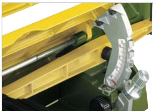
La table peut être réglée de -5° à 50° pour des coupes en biais. Avec un quadrillage de grandes dimensions de 0°, 10°, 20°, 30° et 45°, et un positionnement de précision ajustable.
