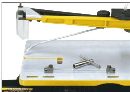
Les pierres de coulisse (breveté) permettent avec un effort élevé, d'assurer un alignement précis des lames. Les cavités dans la surface de la table servent de ligne de guide pour définir la position et l'assemblage de la lame de scie.
