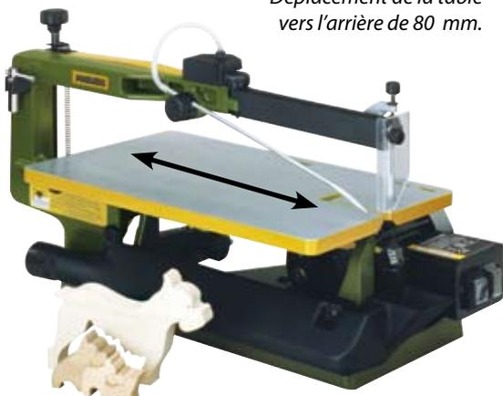
Solution innovante (brevetée): Pour faciliter le changement de lame de scie, on peut déplacer le plateau de 80 mm vers l'arrière de la machine. Pour une vue dégagée du bras de scie inférieur lors du verrouillage de la pierre de coulisse ou de la fixation de lame à ergots.
