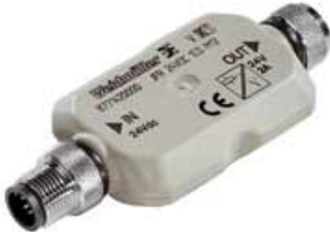
Les interfaces relais JPR en boîtier JACKPAC IP68 existent avec ou sans isolation galvanique. L'amplificateur de commutation amplifie les sorties 24 V DC jusqu'à 2 A max. La tension de commutation est amenée par un répartiteur en T.
