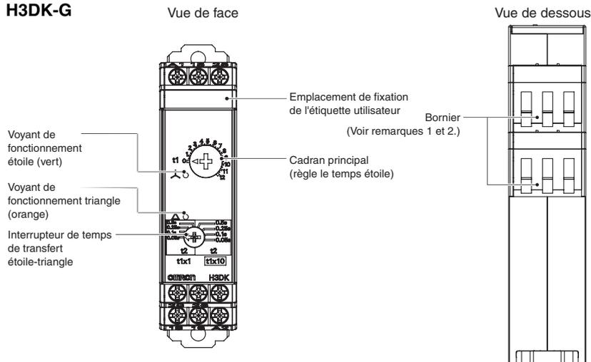
Remarque 1. Utilisez un câble solide (2,5 mm<sup>2</sup> max.) ou des embouts avec des manchons isolants pour connecter les bornes. Pour conserver la résistance de tension après la connexion des bornes, n'insérez pas plus de 8 mm de conducteur exposé dans la broche.
