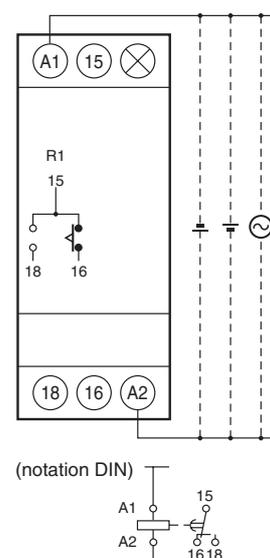
Remarque 1: La figure ci-dessus illustre la disposition des bornes des modèles de 24 à 48 Vc.a./Vc.c. Les modèles dotés d'une entrée d'alimentation de 100 à 120 Vc.a. ou de 200 à 240 Vc.a. n'ont pas d'entrée en c.c.
