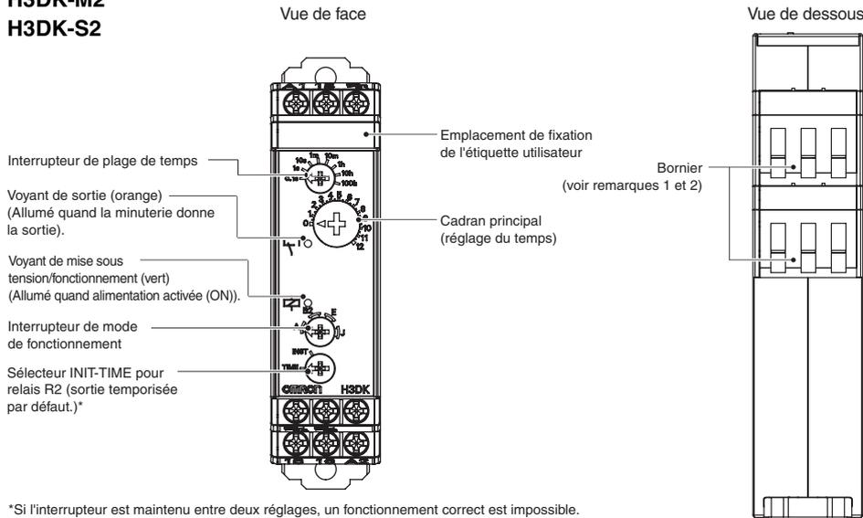
Remarque 1. Utilisez un câble solide (2,5 mm<sup>2</sup> max.) ou des embouts avec des manchons isolants pour connecter les bornes.
