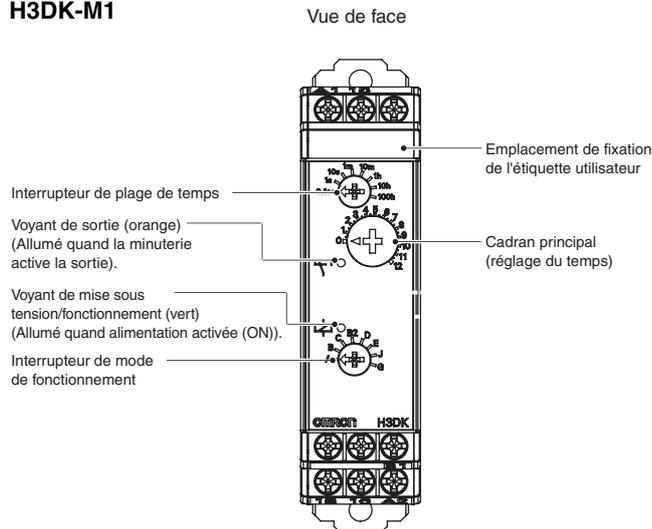
\*Si l'interrupteur est maintenu entre deux réglages, un fonctionnement correct est impossible. Veuillez à ce que l'interrupteur soit correctement réglé.
