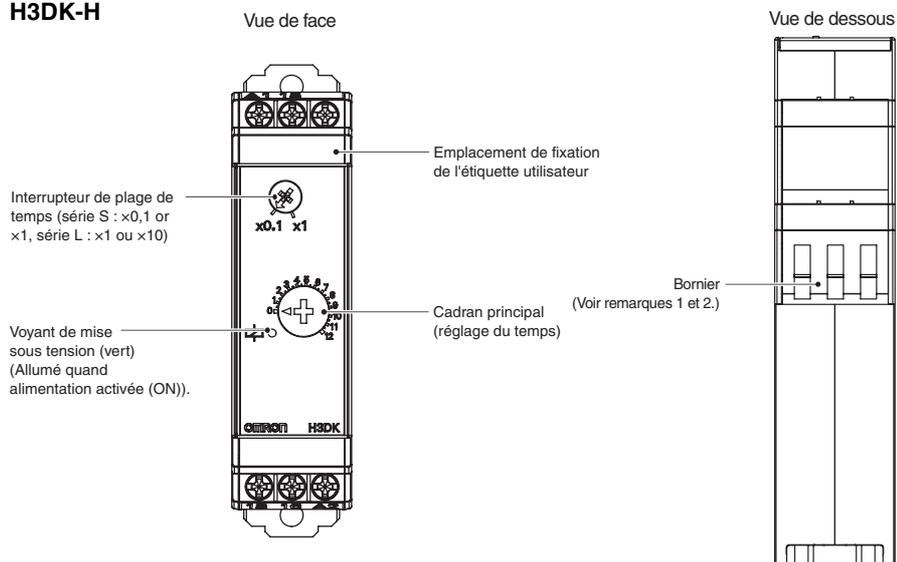
Remarque 1. Utilisez un câble solide (2,5 mm<sup>2</sup> max.) ou des embouts avec des manchons isolants pour connecter les bornes. Pour conserver la résistance de tension après la connexion des bornes, n'insérez pas plus de 8 mm de conducteur exposé dans la broche.
