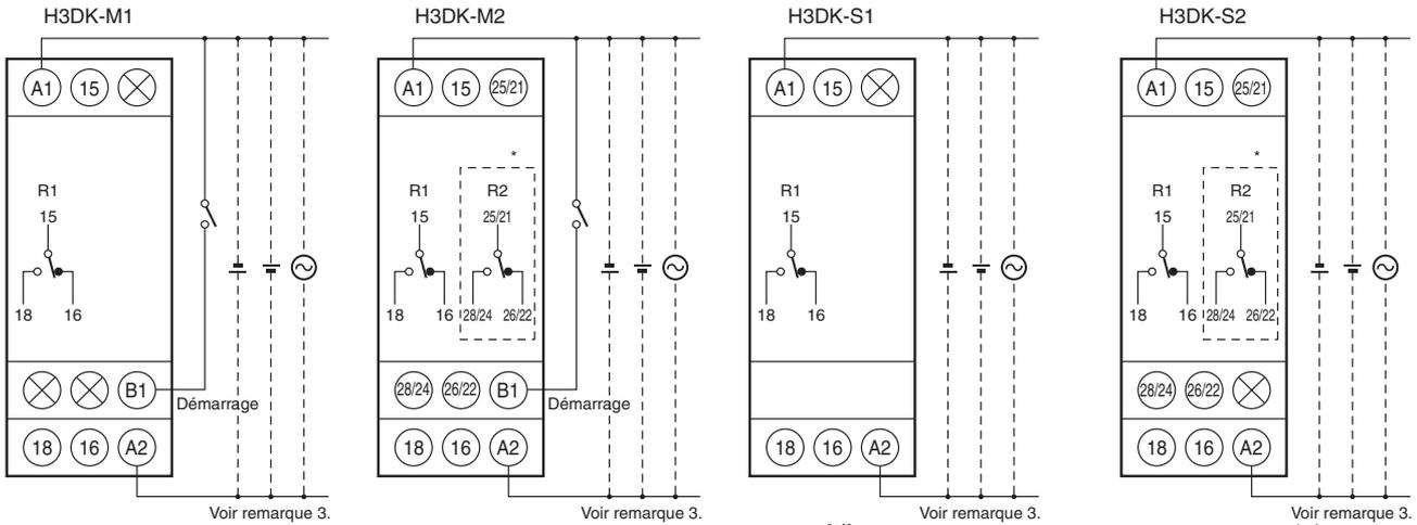
Remarque 1 : le symbole de contact temporisé des précédents modèles de minuterie était . Le symbole de contact temporisé du H3DK est . Un symbole différent est utilisé car le H3DK prend en charge des modes de fonctionnement multiples.
