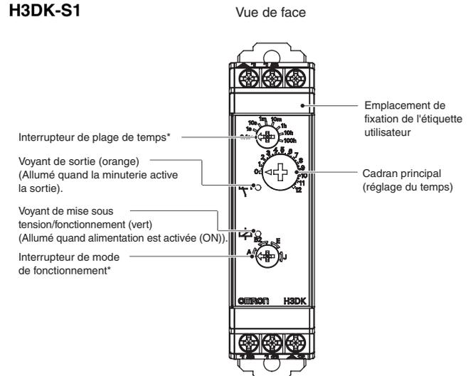
\*Si l'interrupteur est maintenu entre deux réglages, un fonctionnement correct est impossible. Veuillez à ce que l'interrupteur soit correctement réglé.
