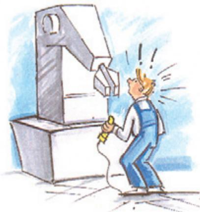
L'enfoncement total du bouton-poussoir à trois positions commande un arrêt à double canal. On doit être sûr que la machine s'arrête en situation de panique.
