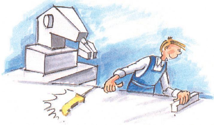
Le relâchement du bouton-poussoir à trois positions commande un arrêt à double canal. On doit être sûr que la machine s'arrête quand on pose la poignée à trois positions, pour le réglage par exemple.
