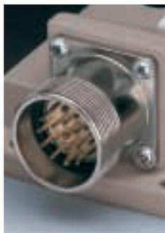
Lors du montage sur la paroi extérieure (panneau avant), l'embase est fixée depuis « l'extérieur » sur l'appareil moyennant des vis, écrous ou un filetage. Côté appareil, l'isolant pour contacts établit la liaison avec l'appareil par une connexion soudée ou sertie.
