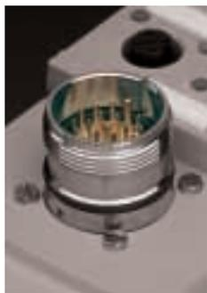
Les embases prévues pour montage sur paroi intérieure (panneau arrière) autorisent un montage rationnel par exemple de circuits imprimés préconfectionnés. Elles s'introduisent de l'intérieur par la paroi de montage et se vissent de l'extérieur.
