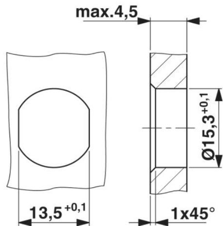
Découpe pour le montage avec protection anti-rotation pour filetage Pg9
