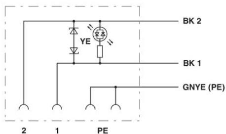
Disposition des contacts du connecteur pour électrovannes
