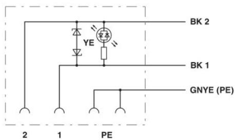
Disposition des contacts du connecteur pour électrovannes
