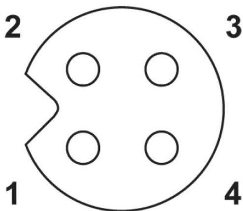
Schéma des pôles, connecteur femelle M5, 4 pôles, vue côté femelle
