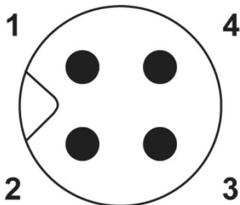
Schéma des pôles, connecteur mâle M5, 4 pôles, vue côté mâle
