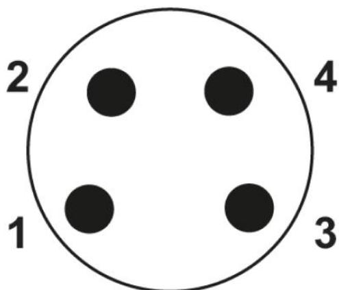
Schéma des pôles, connecteur mâle M8,
