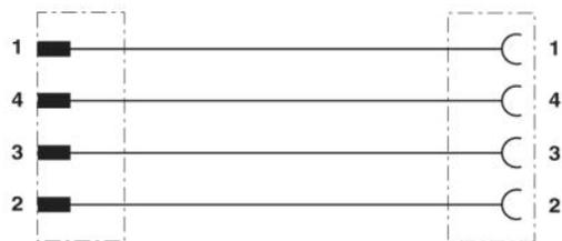
Disposition des contact des connecteurs mâles/femelles M8
