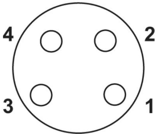
Schéma des pôles connecteur femelle M8 4 pôles, vue côté
