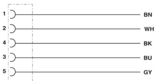
Affectation des contacts du connecteur femelle M12
